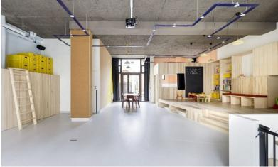
Dans le cadre de ce chantier une cloison en bois a été réalisée servant à délimiter l'espace cuisine de l'espace commun. Des panneaux en triplis frêne olivier de chez Ravier ainsi que des panneaux ardoises Ober et CP peuplier de chez Grosjean viennent habiller la structure. La porte d'entrée de la cuisine est coulissante, le châssis vitré de réemploi (il était dans le local avant les travaux) et un panneau ardoise coulissant permet la fermeture du passe plat au besoin.
