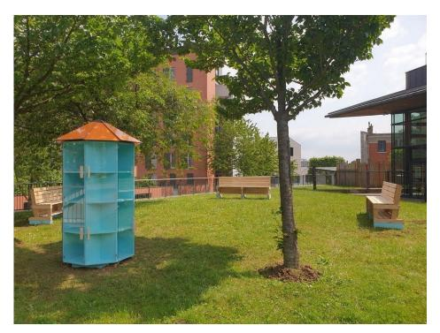
Réalisation d'une boite à livres et de 3 bancs. La boite à livres a été réalisée à partir de tébopin, le toit en compact de réemploi, les polycarbonate portes en transparent et les poignées sur-mesure en châtaignier massif. Les bancs ont été réalisés en châtaignier massif de Picardie provenant de la scierie Jérôme.
